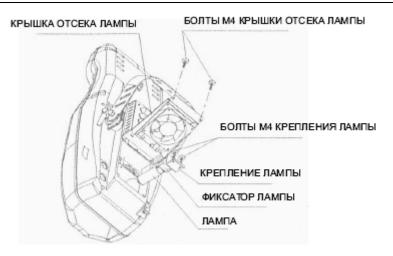
Откройте крышку отсека лампы в нижней части проектора, ослабив два болта М4.
